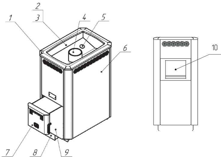
Рис. 16. Конструкция печей-каменок «КУЗБАСС»
