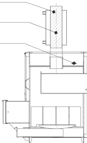
Рис. 7 Схема прочистки печи.
