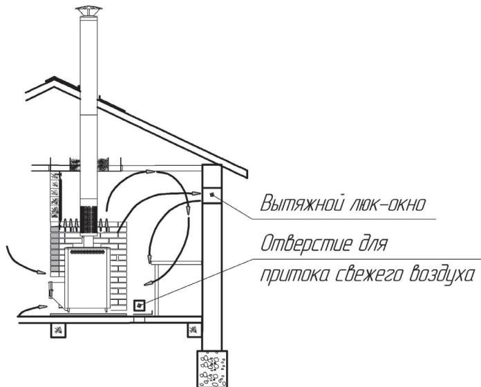
Рис. 5 Схема воздухообмена в парилке
